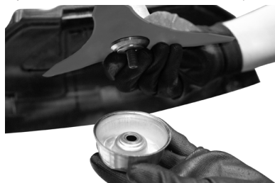
Fig. 8 – Colocando la brida externa
