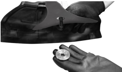
Fig. 8 – Colocando a flange externa
