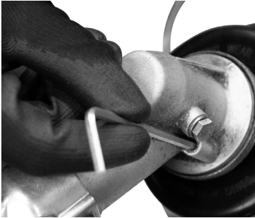
Fig. 11 – Trabando el eje
