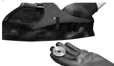
Fig. 8 – Colocando la brida externa
