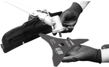
Fig. 7 – Posicionando a lâmina
