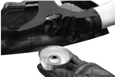
Fig. 8 – Colocando a flange externa
