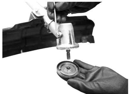
Fig. 6 – Montagem da flange interna
